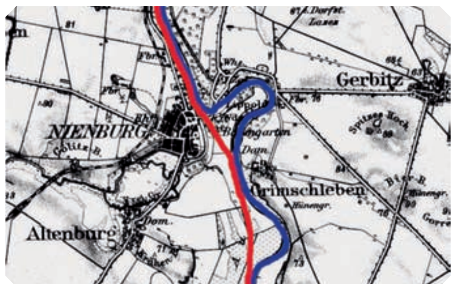
Abbildung 1: Fließveränderung eines Gewässers am Bsp. der Saale bei Nienburg. Der blaue Verlauf stellt den ursprünglichen Saaleverlauf vor Ausbaumaßnahmen dar. Der rote Verlauf zeigt den jetzigen Verlauf der Saale und die Abtrennung der Flußschleifen.
