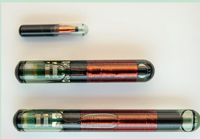
Abbildung 1: PIT-Tags verschiedener Größe (12 x 2 mm, 23 und 32 x 3,9 mm)
